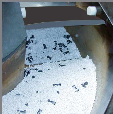
Trennfallstufe: Unterstützt die Vereinzelung flacher Werkstücke
